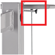
12. ábra: Csillagmarkolatos csavar a kapcsolórúdon, 8t-s fahasító
