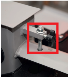
Fig. 11: Stjärngreppskruv på kopplingsstången, vedklyv 7 t
