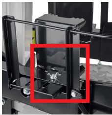
Obr. 10: Křídlová skrutka na zvieracom prípravku dreva
