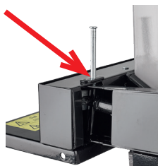
Obr. 4: Os otáčania ovládacieho ramena, štiepačka dreva 8t
