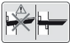
Fig. 9: Häng in klyvbordet korrekt
