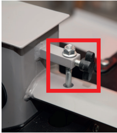
Abb. 11: Sterngriffschraube an der Schaltstange, Holzspalter 7 t
