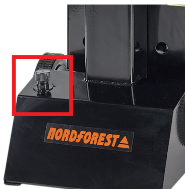
19. ábra: Betöltőcsavar olajsztintmérő pálcával, 8t-s fahasító
