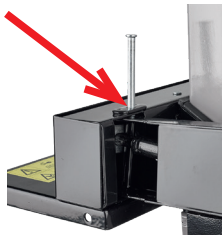
Fig. 4 : Axe de rotation du bras d'actionnement, fendeur de bois 8 t
