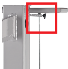
Obr. 12: Skrutka s hviezdnicovitou rukoväťou na spínacej tyči, štiepačka dreva 8 t
