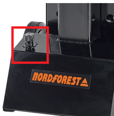
Fig. 15 : Bouchon d'huile, fendeur de bois 8 t
