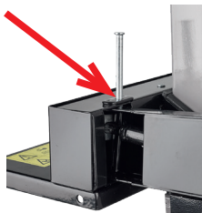
4. ábra: A működtetőkar forgástengelye, 8 t-s fahasító
