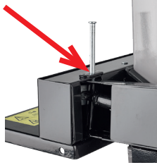
Kuva 4: Käyttövarren kääntöakseli, halkaisukone 8t
