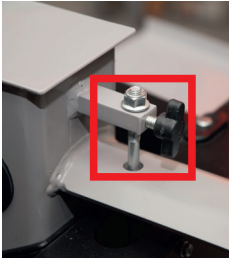
Fig. 11 : Vis à poignée étoile sur la barre de commutation, fendeur de bois 7t
