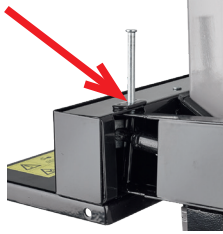
Fig. 4: Manöveringsarmens rotationsaxel, vedklyv 8 t
