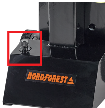
Kuva 19: Täyttöruuvi ja öljyn mittatikku, halkaisukone 8 t
