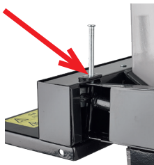
Abb. 4: Drehachse des Betätigungsarms, Holzspalter 8 t
