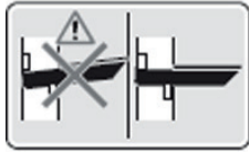
Fig. 9 : Accrocher la table de fendage correctement
