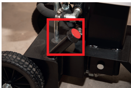
18. ábra: Betöltőcsavar olajsztintmérő pálcával, 7t-s fahasító
