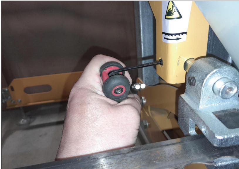
Sichern Sie die Wellen der Blattführungseinheiten in dieser Position mit den M8 x 25 mm Stellschrauben mit Kegelkuppe.
