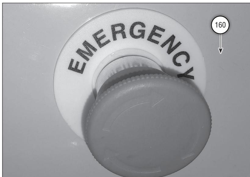
Bringen Sie das Schild „EMERGENCY STOP“ (NOT-AUS) an der Windenwellen-Abdeckung (160) an und platzieren Sie es über dem entsprechenden Loch auf der Bedienerseite des Sägewerks.
