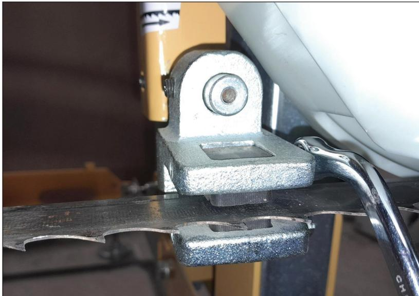
Positionieren Sie die obere Keramikeinlage der Sägeblattführung beider Blattführungseinheiten 1,5 mm bis 3 mm (1/16 bis 1/8 Zoll) über dem Sägeblatt.
