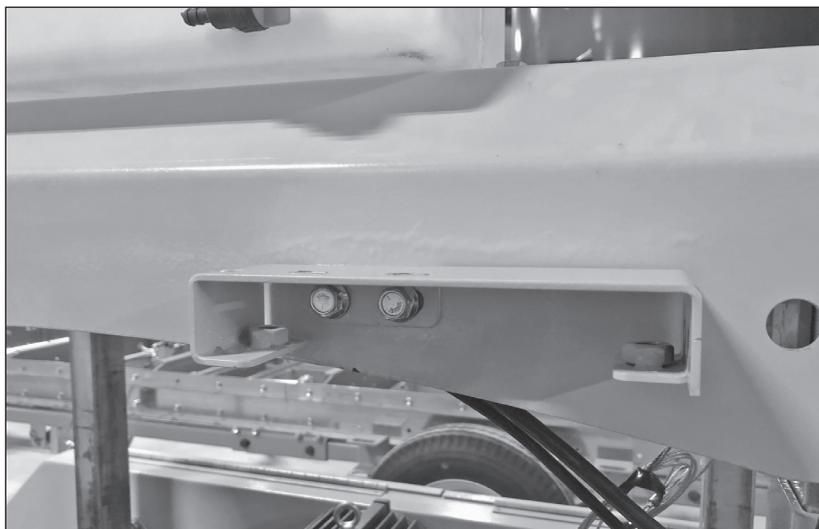
Montieren Sie die Wasserventilhalterung (6) am unteren Bereich der Windenwellenabdeckung und befestigen Sie sie mit zwei 3/8 x 3/4 Zoll Flanschbolzen (genormte Flansche) (4) und den beiden 3/8 Zoll geflanschten Muttern (genormte Flansche) (3). Fest anziehen.
