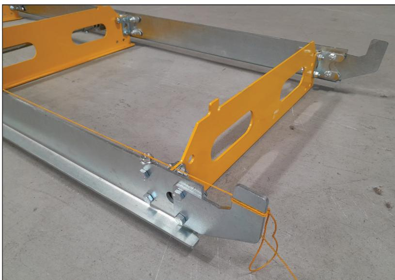
Wiederholen Sie dies für das andere Ende des Bettes und binden Sie die Schnur straff. Legen Sie eine Mutter unter die Schnur, um den Abstand an diesem Ende und am gegenüberliegenden Ende zu markieren.
