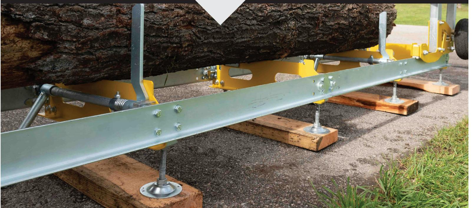
Ihr standardmäßiges Frontier OS18 Sägewerk kann Stämme mit einer Länge von bis zu 2,5 m verarbeiten. Um Stämme einer Länge von 4,0 m zu sägen, fügen Sie eine Verlängerung hinzu - oder fügen Sie so viele Verlängerungen hinzu, wie Sie möchten, um Stämme jeder Länge zu verarbeiten. Jede Sägebett-Verlängerung wird mit dem Ende der Stammauflage verschraubt.
