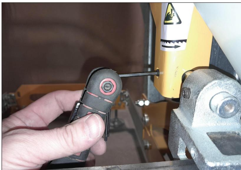
Drehen Sie die Bandräder gegen den Uhrzeigersinn und prüfen Sie, ob das Sägeblatt und die Keramikeinlagen der Blattführung einander behindern. Wenn eine solche Behinderung auftritt, stellen Sie die Keramikeinlagen der Blattführung neu ein, um diese zu beseitigen (stellen Sie sicher, dass die Keramikeinlagen nicht zu nahe am Sägeblatt sind). Beachten Sie den WICHTIGEN HINWEIS am Anfang dieses Abschnitts.
