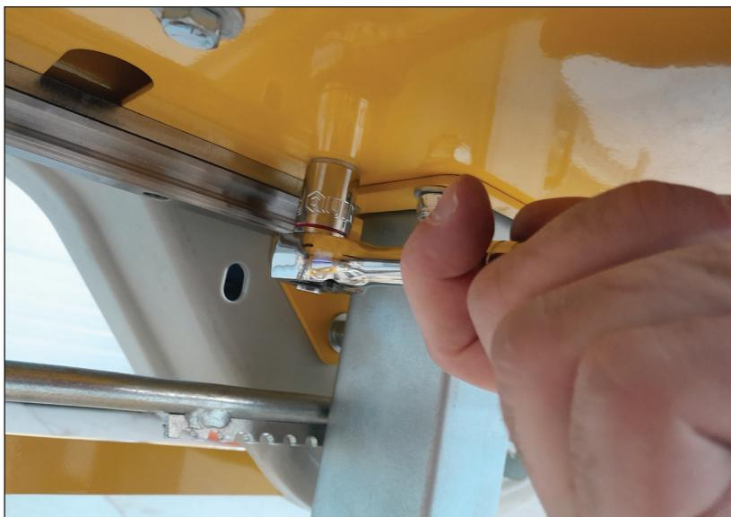
Stellen Sie das 3/8 x 5 Zoll Aufnahmespannschloss von der Unterseite des Sägekopfs aus so ein, dass diese beiden Maße (an der festen Führung und der verstellbaren Führung) übereinstimmen.
