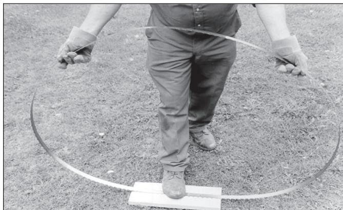
Halten Sie das Sägeblatt mit den Händen nach oben und mit dem Sägeblatt nach oben weisend von Ihnen abgewandt vor sich. Halten Sie die Daumen außerhalb und die Finger innerhalb des Sägeblattes. Sie sollten Ihre Hände etwas weiter als Schulterabstand auseinanderhalten, damit das Sägeblatt ca. 1 m Zwischenraum zwischen den Händen aufweist.
