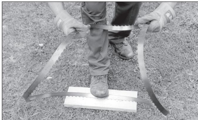
Halten Sie die Unterseite des Sägeblatts mit dem Fuß auf dem Boden und achten Sie darauf, dass die Zähne nicht beschädigt werden. Drücken Sie das Sägeblatt nach innen und drehen Sie gleichzeitig die Handgelenke nach innen und unten.
