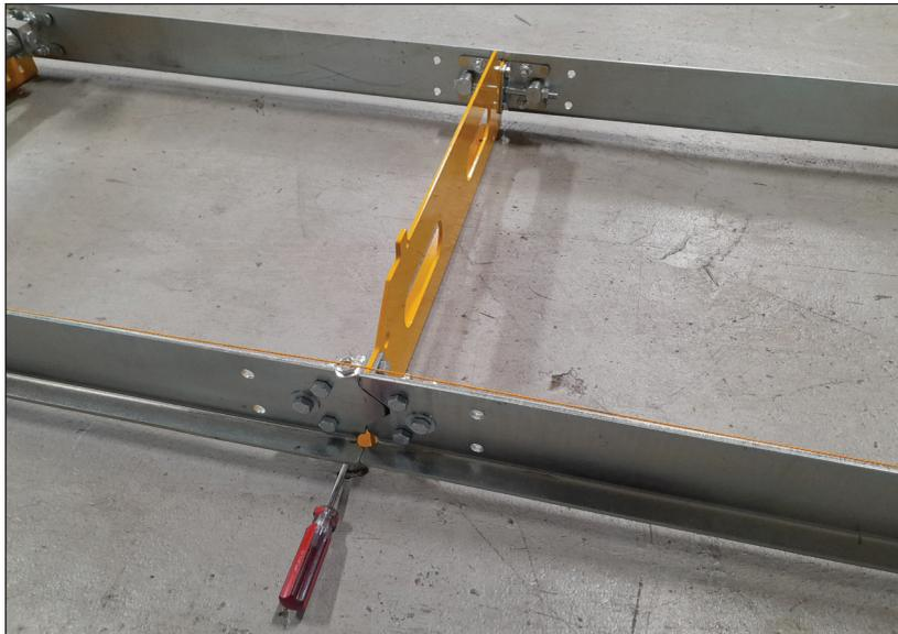
Verwenden Sie gegebenenfalls Unterlegscheiben, damit die Schnur und das Maschinenbett parallel verlaufen. (Verwenden Sie die zuvor platzierten Muttern als Orientierungshilfe).
