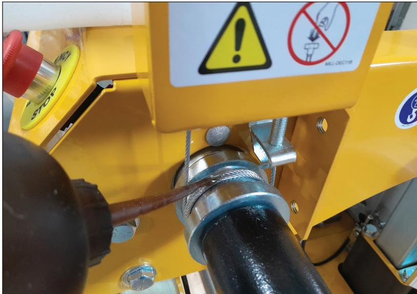
Geben Sie ein paar Tropfen Öl auf die Bremstrommel der Winde bzw. das Windenseil.
