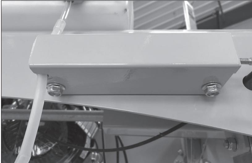
Bringen Sie die Abdeckung des Wasserventils (7) auf der Wasserventilhalterung (6) an und befestigen Sie sie mit zwei 3/8 x 3/4 Zoll Flanschbolzen (genormte Flansche) (4). Fest anziehen.
