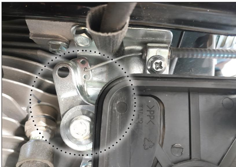
Beim Einstellen des Gaskabels muss der Steuerhebel gedrückt werden.
