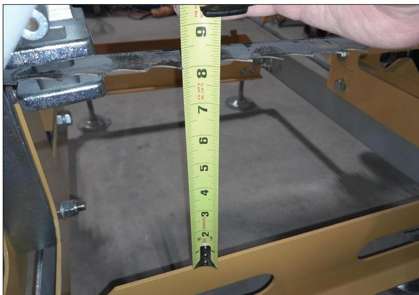
Wenn das Sägeblatt richtig gespannt ist (siehe Abschnitt „Montage, Spannung und Spurlauf des Bandsägeblatts“), positionieren Sie den Sägeschlitten so, dass sich das Sägeblatt direkt über einem Querträger befindet.
