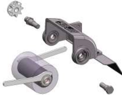
Fig. 11: Cambio del cepillo rotativo
