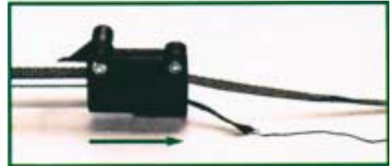
15. Den Draht soweit ziehen, bis das Zugband erscheint.
