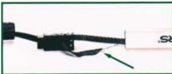
14. Das Zugband in die Rolle einführen. Ein Loch in das Zugband stechen und so den Draht einhaken
