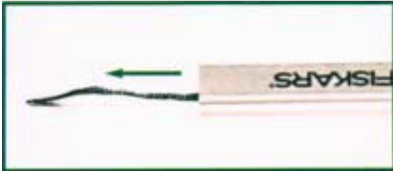
10. Das Zugband kommt aus dem Rohr.
