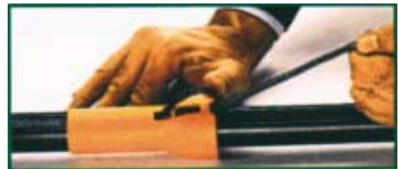
19. Das Zugband festziehen und die Klingen des Gerätes kontrollieren.
