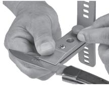
**CONSEIL DE PRO:** Pour obtenir de meilleurs résultats, l'écart à l'arrière de l'étau doit être égal ou supérieur à l'écart à proximité des mâchoires à l'avant de l'étau. Environ 5/8" (1,6 cm) po de la lame doit être exposée au bout de l'étau. Dans le cas de lames de moins de 1/2" (1,25 cm) po de largeur, ou pour aiguiser à un angle de 17° sur la plupart des lames, remplacer la vis de serrage avant par la vis plate fournie.
