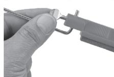
Coloque la piedra de afilar sobre una superficie llana, con el lado con piedra hacia abajo. Afloje el tornillo de mariposa y meta la varilla para guía de abajo hacia arriba, como se muestra a continuación. Asegúrese de que la piedra de afilar y la varilla estén completamente planas sobre la superficie llana. Para sujetar firmemente la varilla, **apriete con los dedos solamente** el tornillo en el asidero de la piedra de afilar.
