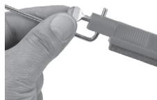
Prüfen Sie die Geradheit und Angleichung mit dem Schleifstein gegen eine ebene Fläche. Versichern Sie daß Stange und Schleifstein die ebene Fläche an der gesamten Länge entlang berühren. Sollte die Stange mit dem Stein nicht eben sein, dann zum Angleichen mit **leichtem Fingerdruck** biegen.
