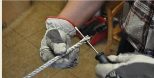
2. Auftrennen des Seilverbandes in zwei Teile. Die Stahlseele wird einem Teil zugeordnet.
