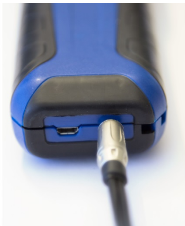
Abb. 13: Geräteunterseite mit angeschlossenen Kabel der Einschlagssonde
