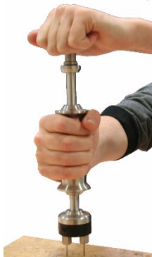
Abb. 16: Einschlagen der Wöhler Einstechsonde
