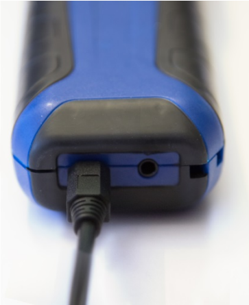
Abb. 23: Geräteunterseite mit angeschlossenen Kabel der Feuchtwage
