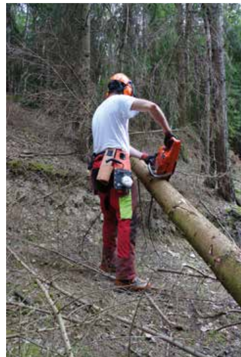
Beim Entasten der meisten Nadelbäume geht man vom Stammende aus am Stamm entlang in Richtung Krone und schneidet die Äste (auch Beulen) nach drei Hauptentastungstechniken ab: Hebelmethode, Scheitelmethode und Pendelmethode. Beim Vorlaufen muss sich der Stamm zwischen Motorsäge und Sägenführer befinden. Die Stammlänge kann erfasst werden, indem man das Maßband am Stammfuß einhakt und mitlaufen lässt.
