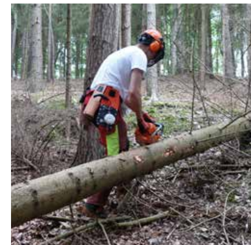
Oben: Spiegelei, das beim stammebenen Abschneiden von Ästen entsteht; darüber unsauberer Aststummel. Unten: Abschneiden von Ästen auf der Seite, auf der sich der Motorsägenführer befindet.
