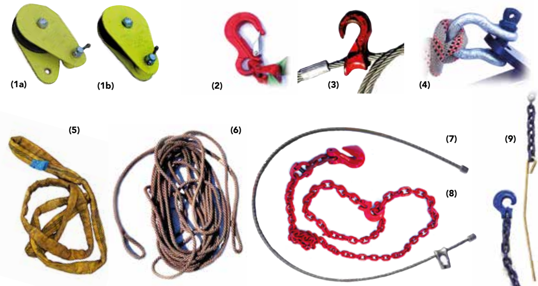
(1a und 1b): Geöffnete und geschlossene Umlenkrolle. Wichtig ist, den Knebel nach Verschluss eine viertel Umdrehung zu lockern, damit man ihn nach der Arbeit wieder leicht öffnen kann. (2) Lasthaken mit Sperrklinke, (3) Gleithaken mit Stahlseil, (4) Schäkkel mit Schraubsicherung, um z.B. ein Kunststoffseil mit einem Stahlseil zu verbinden oder einen Fällhaken anzuschließen. (5) Rundschlinge mit WLL-Werten (pro Strich 1 t WLL, hier also 3 t), (6) Kunststoffzugseil, (7) Würgeschlinge aus Stahl (Chokerseil) mit Chokerhaken, (8) Chokerkette (Würgekette) mit Parallelhaken oben und einem Schlinghaken in der Mitte, durch den die Kette hindurchgleitet, so dass sie sich am Stamm zuzieht. (9) Durchstecknadel, mit der die Kette unter einem Baum durchgezogen werden kann.
