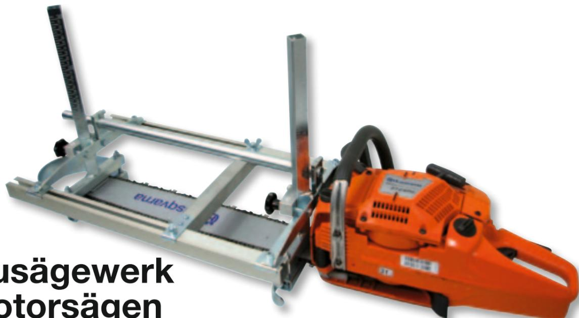
Das Anbausägewerk wird am Schwert der Motorsäge durch Ankleben befestigt, so daß es für fast alle Sägen Verwendung finden kann. Voraussetzung ist ein Sägeschwert mit mindestens 58 mm Breite. Die Motorsäge sollte pro 10 cm Schnittbreite ca. 0,75 kW Leistung haben, um eine Überlastung zu vermeiden. Durch den Einsatz einer speziellen Längsschnittkette erhält man eine saubere Oberfläche und steigert die Schnittleistung.
