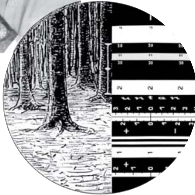
Abb. 10: Blick durch das Spiegel-Relaskop Metrisch Standard bei der Distanzmessung mit 2 m-Vertikalbasis
