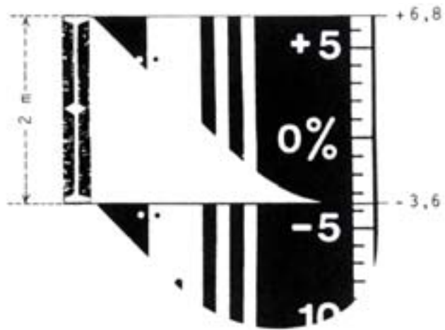
Abb. 11: Distanzmessung mit der 2-m Vertikalbasis unter Verwendung der Prozentskala des Spiegel-Relaskopes Metrisch CP
