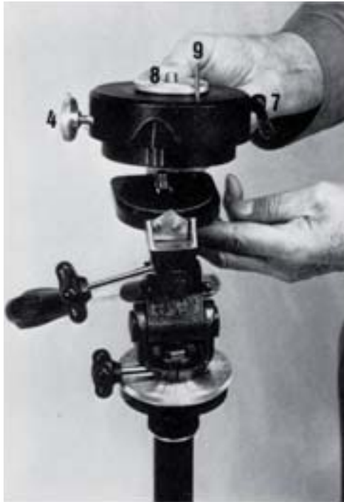
Abb. 14: Die Feineinstellung wird auf dem Neigekopf montiert
