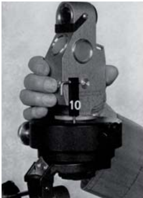
Abb. 15: Anschlag mit Vorrichtung für die Fixierung des Pendel-druckknopfes (Knopfdrücker)
