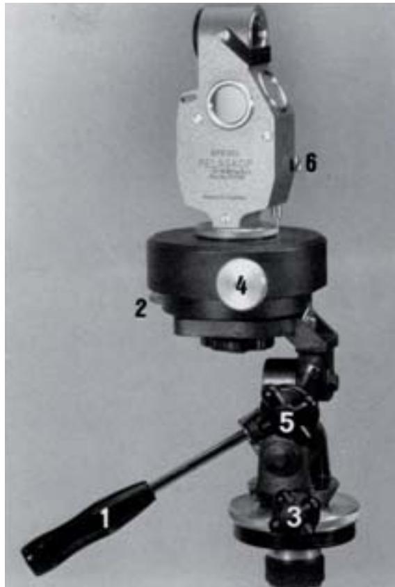
Abb. 13: Das Spiegel-Relaskop auf Stativ mit Neigkopf und Feineinstellung für Präzisionsmessungen
