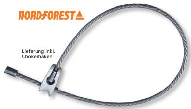
Nordforest Chokerseil FTF 8,5t: Stahlkopf – Choker – Stahlkopf (28 mm), Mindestbruchlast 18,1t, Nutzlast 8,5t
