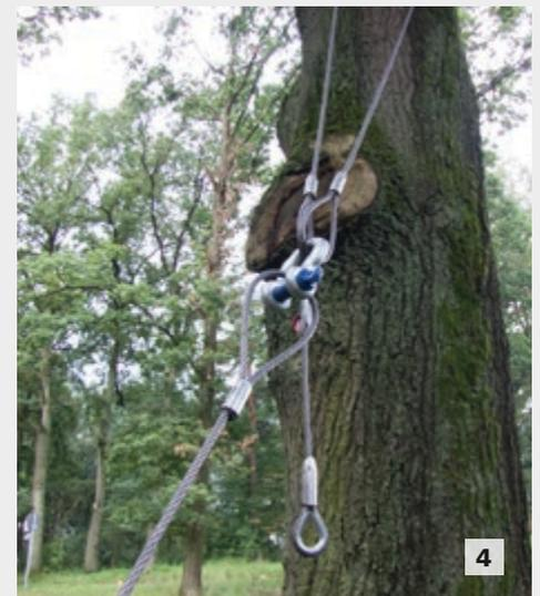
4. Die Schlaufen des Baumzugseiles werden anschließend mittels Schäkel mit dem Hauptwindenseil verbunden, sodass das Baumzugseil umgelegt um den zu ziehenden Baum liegt.
