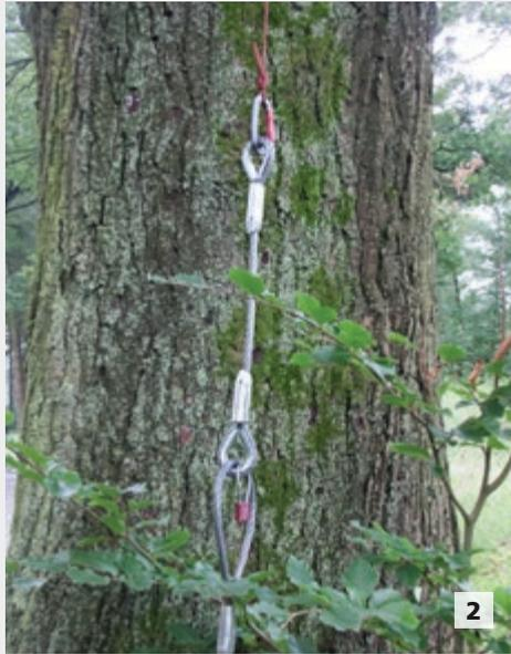
2. Die Einzugsöse des Stahlseiles wird mit dem kleinen Karabiner am unteren Ende der Reepschnur befestigt. Nun zieht man das Stahlseil mit der Reepschnur hoch in den Baum und über die Astgabel.
