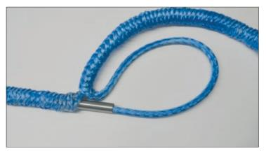
Das andere Seil wird gegenläufig dem Ersten an der Einspleißlänge eingespleißt.
