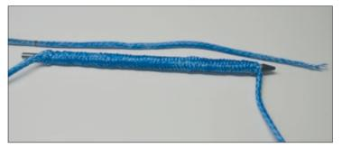
Direkt an der Markierung der Einspleißlänge wird das Spleißrohr eingeführt, und, wie bereits beschrieben, das andere Seilende eingeführt.
