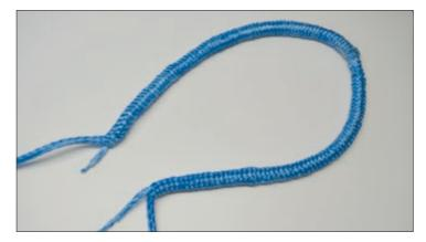
Durch Ziehen an den ausgedünnten Seilenden werden beide Seile an der Einspleißstelle zusammengezogen.
