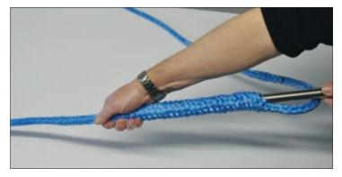
Schieben Sie das ganze Spleißrohr durch das Seil, indem Sie das Seil auf dem Rohr zusammenschieben.
