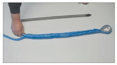
Setzen Sie die Kausche ein, ziehen Sie das eingespleißte Ende gegen die Kausche.
