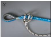
Anschließend wird das Textilseil abermals unter dem Hauptseil hindurchgeführt. Das Ende des Textilseiles nun durch die sich bildende Öffnung führen.
