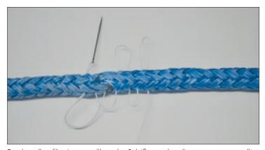
Durch wellen förmiges vernähen der Spleiße werden diese gegen ungewolltes Lösen gesichert.
