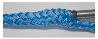
Stecken Sie das Spleißrohr mit der Spitze in das Seil, indem Sie das Seil zusammenschieben, so dass sich ein Hohlraum bildet (Ziehharmonika). Durch diesen Hohlraum schieben Sie das Spleißrohr bis zur letzten Markierung.
