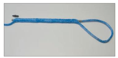
Entfernen Sie die Spitze vom Spleißrohr und führen Sie das Ende hinein.
