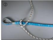
Das Textilseil wird einmal um das Hauptseil gelegt und über Kreuz zurückgeführt.
