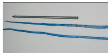
Gerissene Seile oder Seile zur Verlängerung werden mit einem gegenseitigen Spleiß verbunden. Markieren Sie, wie bereits beschrieben, die Verjüngung und die zweifache Rohrlänge = Einspleißlänge. Wiederholen Sie dies am anderen Seileinde.
