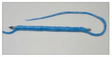
An der letzten Markierung führen Sie das Spleißrohr heraus (Sollte das Seil nicht auf das Rohr passen, können Sie gleichzeitig das Seilende in das Rohr stecken und mit durchführen.
