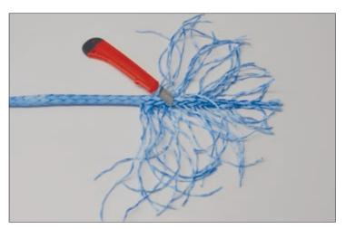
Verjüngen Sie das kurze Seilende, indem Sie gleichmäßig bis zur Spitze einzelne Garne herausziehen und abschneiden.
