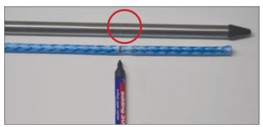
Auf dem Spleißrohr ist eine Markierung für die Verjüngung des Seiles angebracht: kurze Seite.
