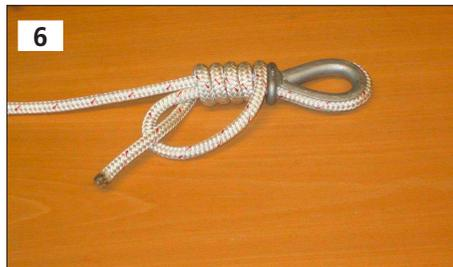
6 Nach fünf Windungen führen Sie das Ende durch die Schlaufe heraus.
