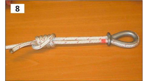
8 Drehen Sie die Windungen des Knoten zusammen. Durch Ziehen am losen Ende festigen Sie den Knoten zusätzlich.
