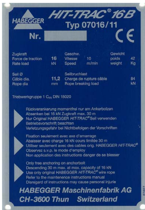
HIT-TRAC 16 B Typenschild mit Typennummer und technischen Daten
