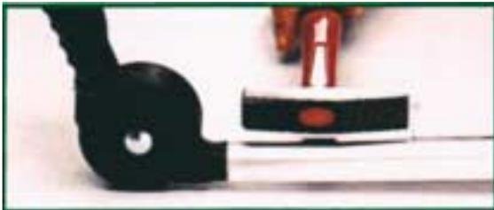
2. Den Kopf mit Hilfe eines Hammers rauslassen.
