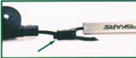
11. Das Zugband durch die Rolle ziehen.
