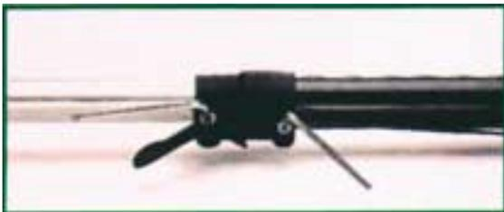
4. Die Schrauben des Blockiersystems lösen.
